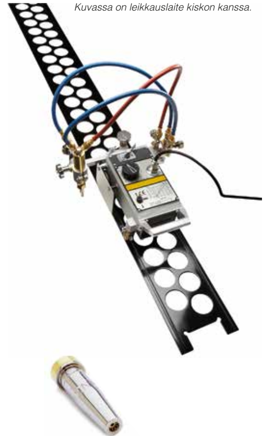
Kuvassa on leikkauslaite kiskon kanssa.
